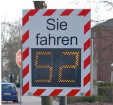
Die Anzeigetafel misst die Frequenz der reflektierten Welle und berechnet daraus die Geschwindigkeit.
