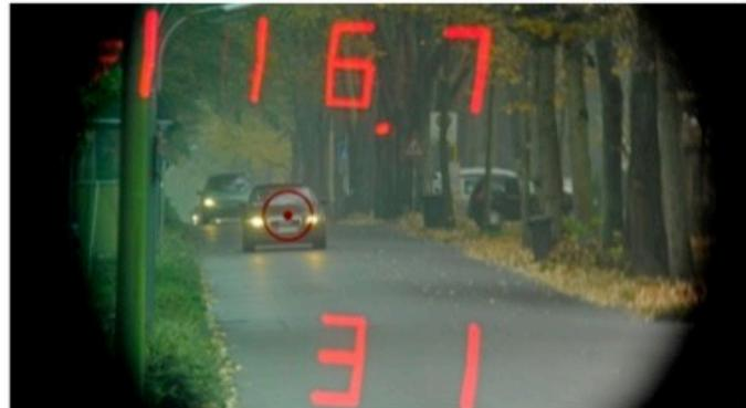
Die Laserpistole zeigt bei einer Entfernung von 116,7 m eine Geschwindigkeit von 31 km/h an.
